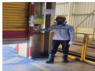
ภาพที่ 5 Trimmer Operator ใส่หน้ากาก พร้อมตลับกรอง ควบคุมการเปิด-ปิดประตู Shutter 28-E-CP ให้ทีมงานออก
