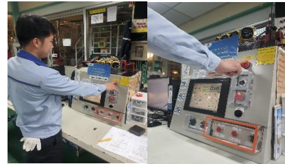
ภาพที่ 3 พนักงานกดปุ่ม Emergency Shut Off Valve ตามคำสั่งของ OC และโทรแจ้งทีมค้นหา-ช่วยชีวิต RCL และทีมฉุกเฉิน Linde
