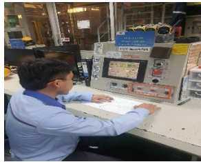
ภาพที่ 2 Overall Technician ตรวจสอบค่าจาก Gas Detector ที่จอ Monitor
